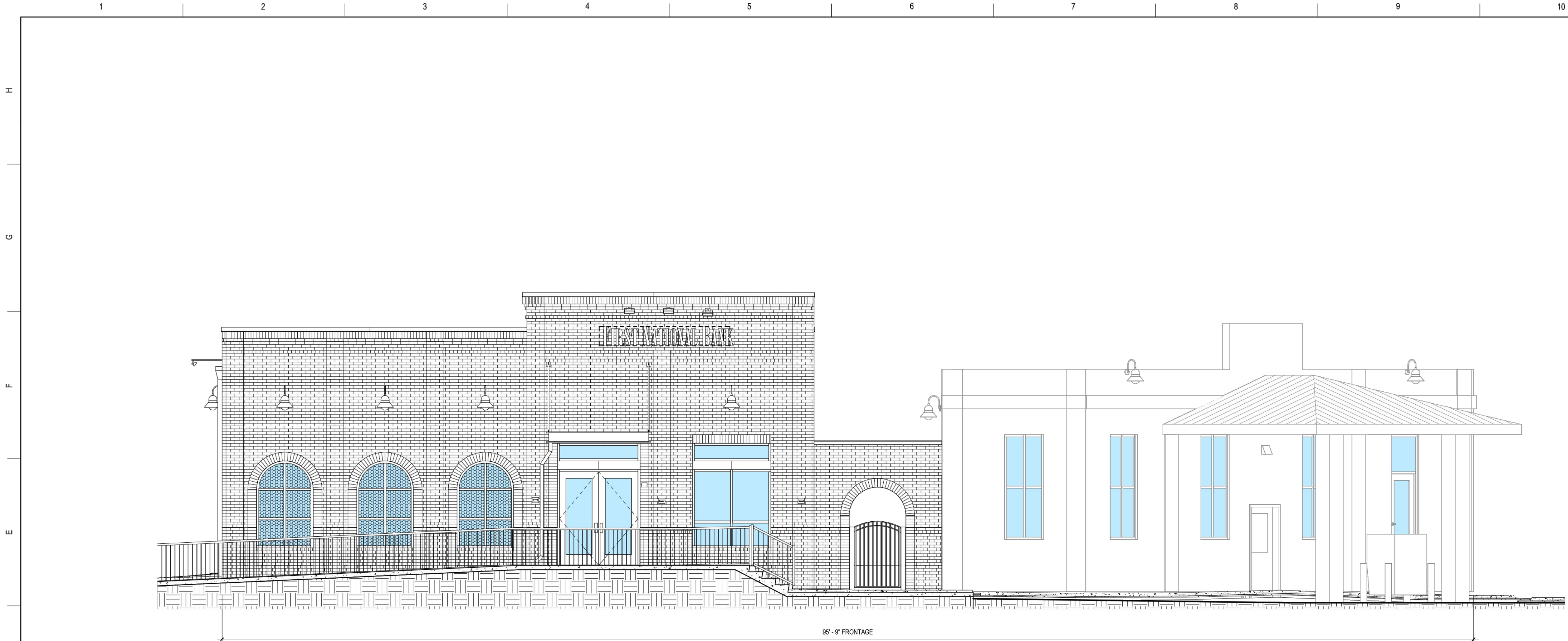
D1 FRONTAGE ELEVATION A303 1/4" = 1'-0"
